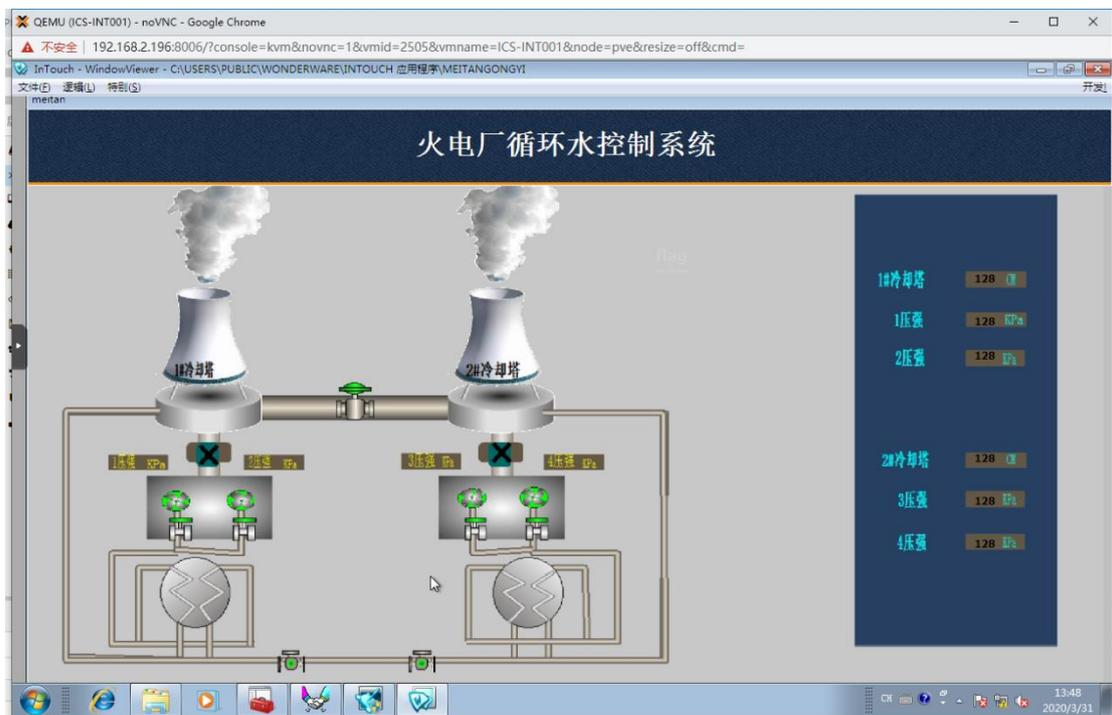
图 2 某火电厂 SCADA 画面（场景）
